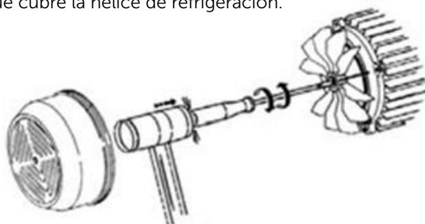
Compruebe que el sentido de giro del motor coincide con el de la placa de características (el ventilador del motor debe girar EN EL SENTIDO DE LAS AGUJAS DEL RELOJ visto desde atrás). En el caso de una bomba trifásica, si el sentido de giro es erróneo, es necesario intercambiar en el disyuntor dos fases de la línea de alimentación.
