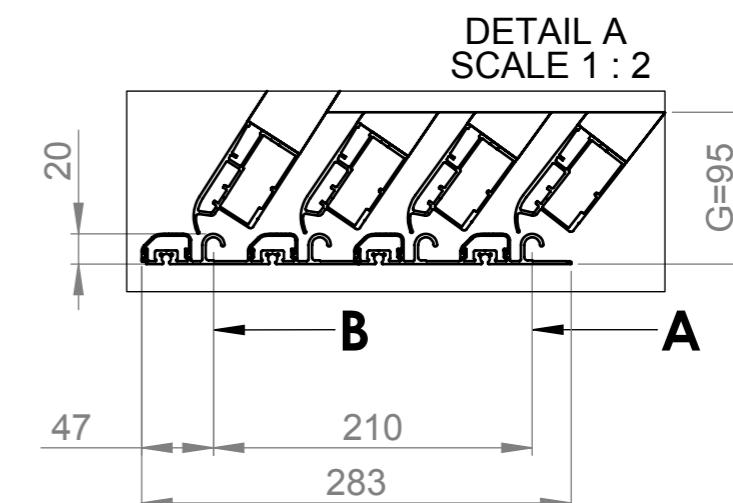
Ce croquis représente uniquement la forme et les dimensions de l'abri. Le fabricant se réserve le droit de modifier l'emplacement, le nombre et le type de profilés utilisés.
